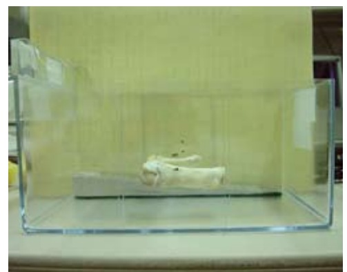
水槽に太さの違う豚の骨を入れたファントム（小児股関節ファントム） 水の量を変化させ被写体厚を変える
